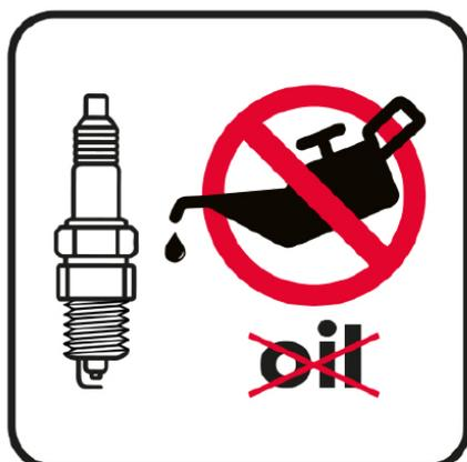
При монтаже не использовать дополнительные смазки на резьбовой поверхности.
